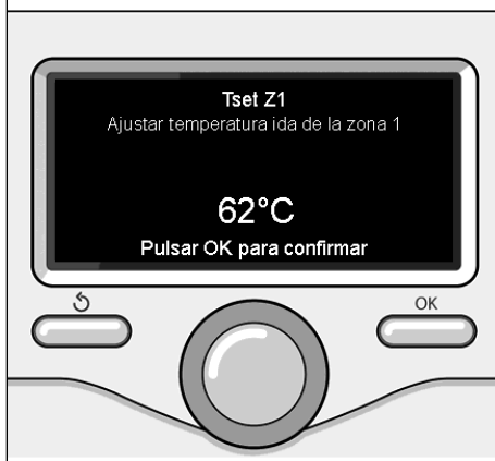
Modificar la temperatura agua caliente calefacción
